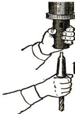
4. Удалить сверло (или патрон со сверлом) из шпинделя станка. Удалить сверло из переходной втулки. Вставить клин узким концом в прорезь шпинделя. Придерживая левой рукой сверло (или патрон), наносить молотком легкие удары по широкому концу клина до тех пор, пока сверло (патрон) не выйдет из шпинделя.
