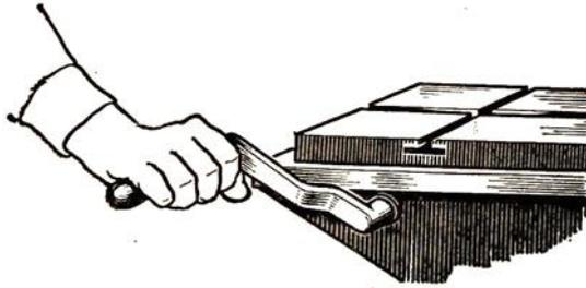
*Примечание.* Подъемом или опусканием стола регулируют положение заготовок относительно сверла.
