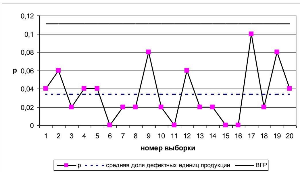
5 **Вывод:** на p-карте нет признаков разлаженности процесса. Поэтому процесс следует считать стабильным.
